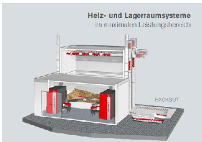
Abbildung 15: Holzheiz- und Lagerräume – Modulbauweise, Systemschaubild Quelle: Fa. Hargassner
