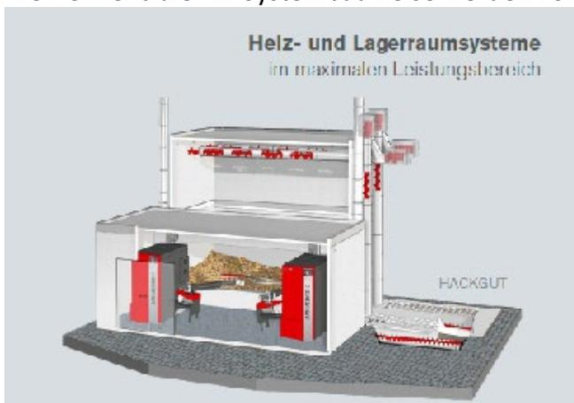
Abbildung 16: Holz hackschnitzelanlage – Modulbauweise, Systemschaubild
